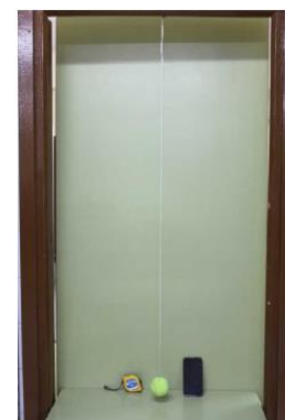
Figura 2. (Izq.) Materiales necesarios para llevar a cabo la determinación de la aceleración de la gravedad. (Der.) Forma sencilla de improvisar un péndulo simple.
