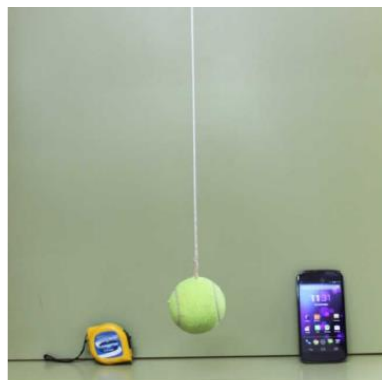
Figura 2. (Izq.) Materiales necesarios para llevar a cabo la determinación de la aceleración de la gravedad. (Der.) Forma sencilla de improvisar un péndulo simple.
