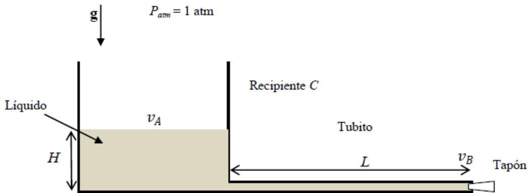
Considere el dispositivo de la figura. El mismo consiste de un recipiente C que tiene una sección transversal  $A$ . En su parte superior está abierto y en la parte inferior de su pared lateral tiene instalado un tubo circular delgado de sección transversal  $a$  y longitud  $L$  con un tapón en un extremo.
