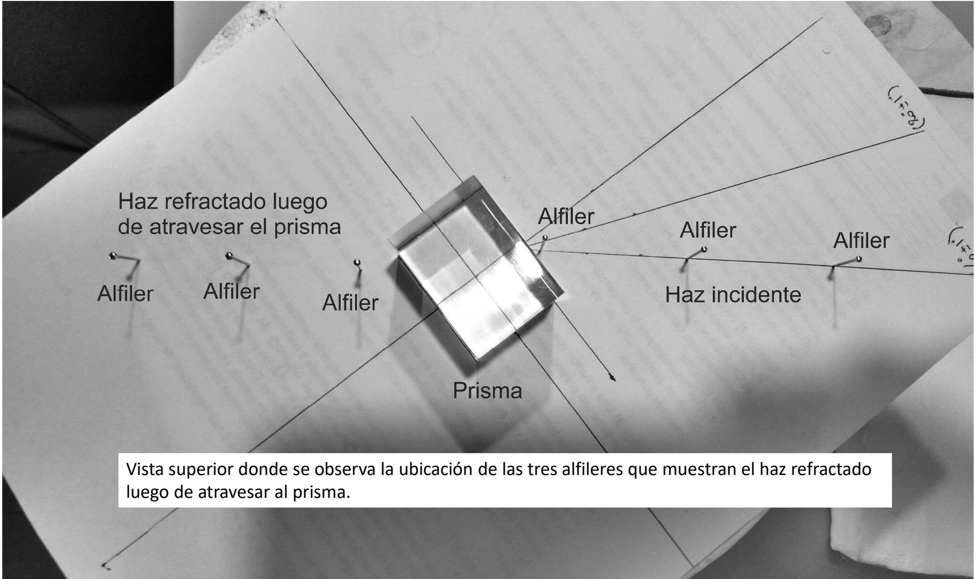
Vista superior donde se observa la ubicación de las tres alfileres que muestran el haz refractado luego de atravesar al prisma.
