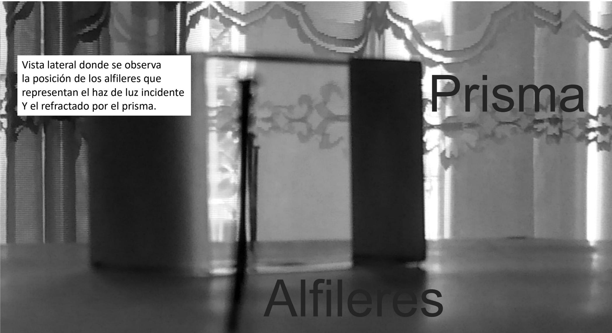
Hoja con la recta del haz refractado por el prisma determinada con los alfileres (Haz refractado por el prisma). Esta recta se extendió hasta la cara del prisma correspondiente al observador.
