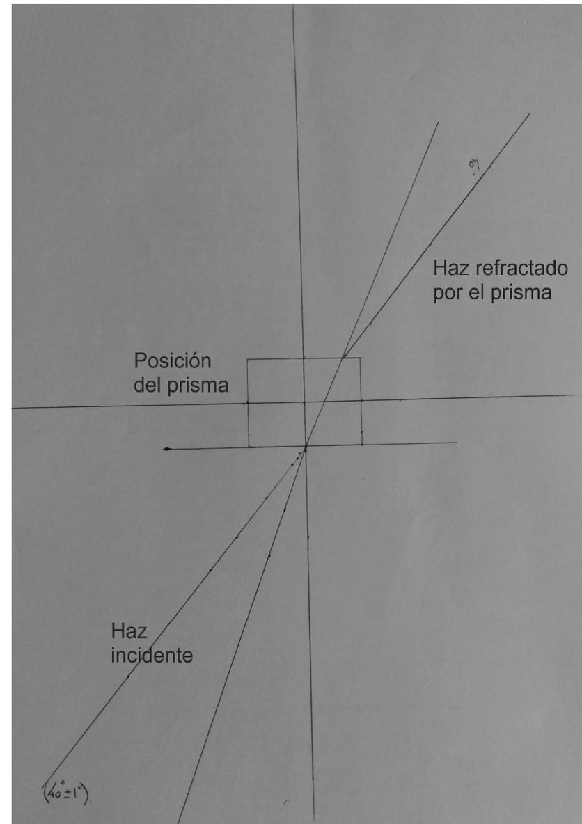
Se muestra la recta que representa al trayecto del haz dentro del prisma junto con los ángulos incidentes y refractados que se deben medir.
