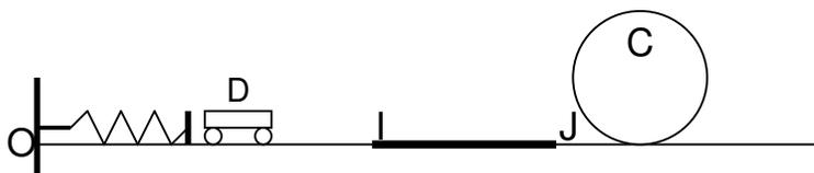
Calcule la constante elástica del resorte para que pueda llegar al punto C y pueda dar la vuelta.
