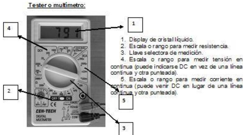
Fig 3: Tester o multímetro:
