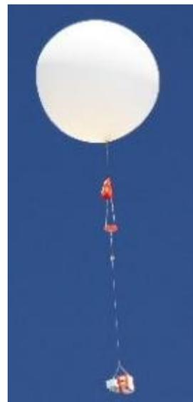
Para los cálculos vamos a suponer que el globo que utilizaremos tiene forma esférica y que el gas en su interior ( $H_2$ ) se comporta como un gas ideal, el cual está sometido a la presión atmosférica y a la presión que le ejerce el globo. La presión que ejerce el globo sobre el gas depende del radio  $r$  que tiene el globo y puede aproximarse por
