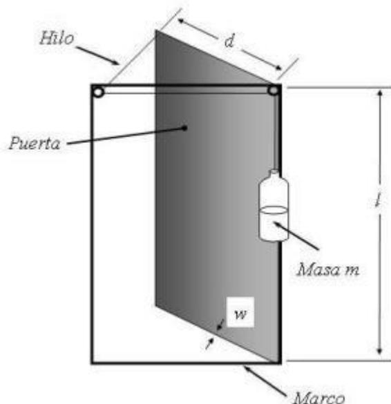
máximo de 90 grados, el frasco con agua descende por su peso, haciendo que la puerta se cierre debido a la fuerza transmitida por el hilo. Suponemos en adelante que al cerrarse completamente la puerta se produce un choque perfectamente inelástico y no se consideran en ningún lugar del sistema fuerzas de rozamiento que pudieran existir.
