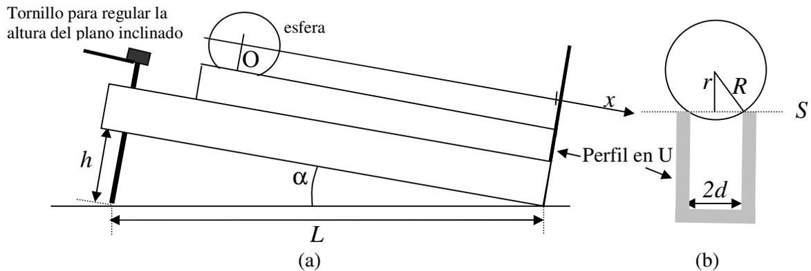
Figura 1: Vista lateral (a) y frontal (b) del dispositivo experimental.
