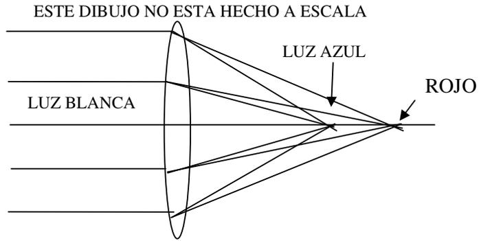
Teniendo presente que el índice de refracción es función de los colores (o longitud de onda) como se muestra en la tabla para dos tipos de vidrios diferentes
