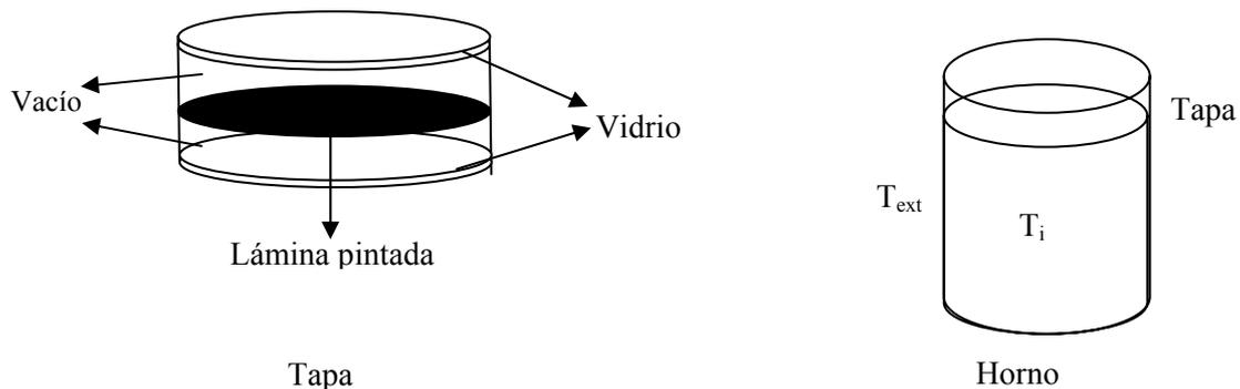
la temperatura del interior del horno. Esta tapa puede ser colocada con el lado negro o el plateado hacia fuera.
