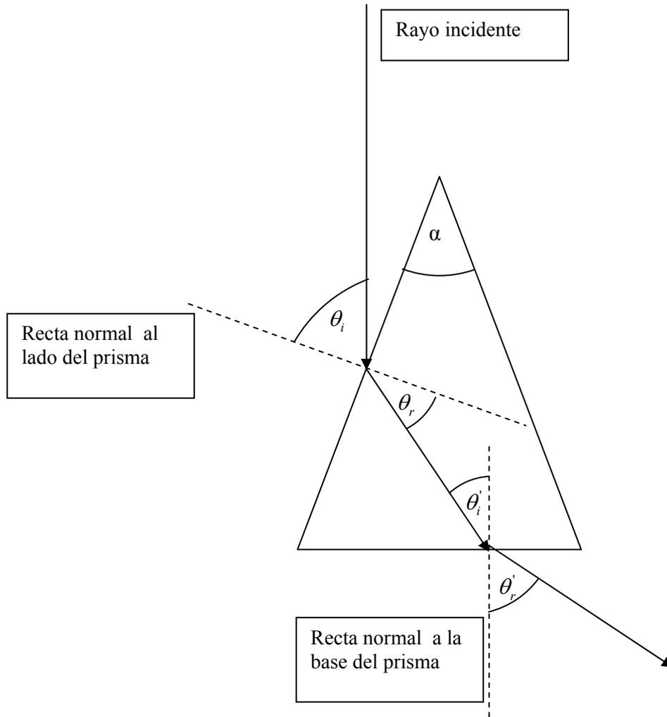
**Figura 3: Diagrama no a escala de uno de los rayos que inciden en el prisma y sus respectivas refracciones. Los ángulos se han exagerado para mayor claridad en el dibujo.**
