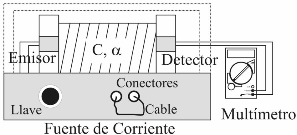
Figura 2: Dispositivo Experimental. Configuración para medir  $R$ .
