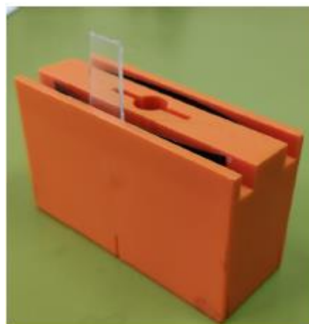
Figura 1 – Red de difracción en el portadiapositivas.
