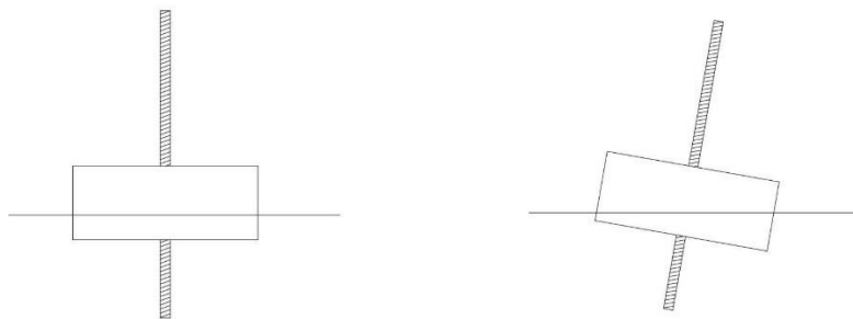
Paralelepípedo flotante adrizado y escorado
